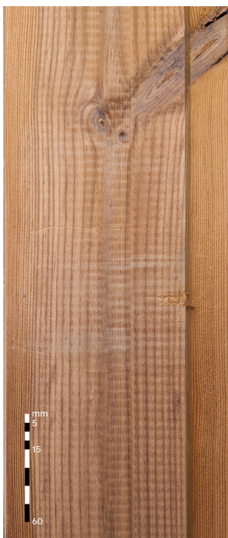
Hõõveldusjäljed (alates 0,5 mm sügavusest) A klass: Keelatud B klass: Lubatud, piiranguteta
