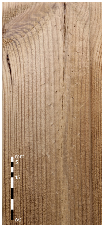
Otsamõrad läbi laua paksuse A klass: Lubatud, mitte suuremad kui laua laius B klass: Lubatud, kuni 300 mm
